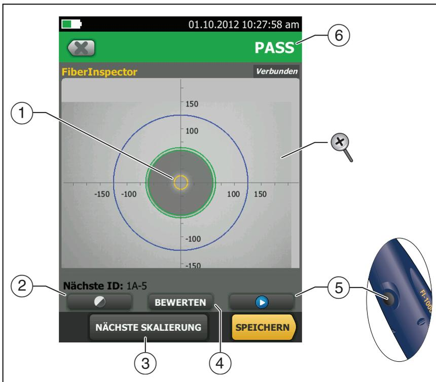
Abbildung 38. FiberInspector-Bild unter Auswahl der manuellen Bewertung
